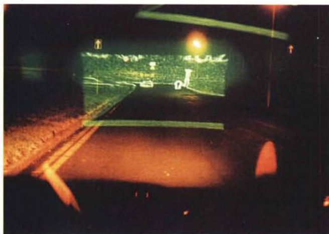
Fig. 7: Nel sistema ad intensificazione di luce di Jaguar abbiamo una telecamera ad infrarossi connessa ad un sistema di acquisizione e di elaborazione che definisce i contorni della strada e degli oggetti presenti innanzi al veicolo e ne propone la visione al guidatore tramite un sistema di proiezione. La visualizzazione avviene sul parabrezza, sovrapponendosi alla vista reale ed aggiungendo ad essa particolari altrimenti invisibili.
